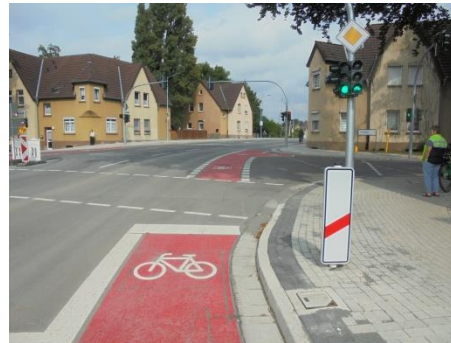
Abb. 4.1-5 Vorgezogene Radaufstellfläche und Fahrrad-LSA Marl, Römerstraße (Quelle: Stadt Marl)
